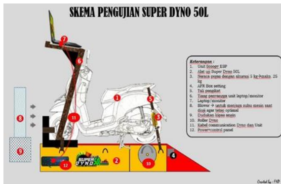
Gambar 1. Skema Uji Dynotest
